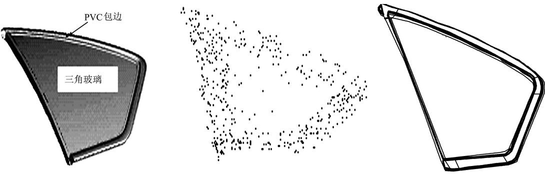
(a) 包边玻璃及其 PVC 包边 (b) 扫描包边玻璃得到的点云 (c) 由点云拟合的各曲面片边界曲线
