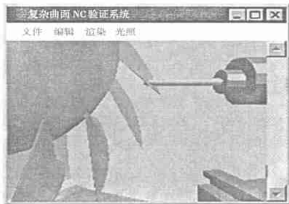
图4 开式叶轮碰撞检测实例
