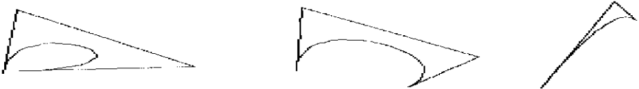
图4 控制多边形中相邻两边的夹角为锐角情形
