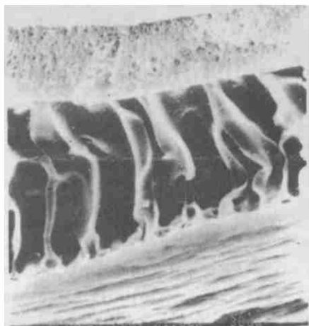
附图 含 7%PEG-2 000 超滤膜的 扫描电镜(SEM)照片
