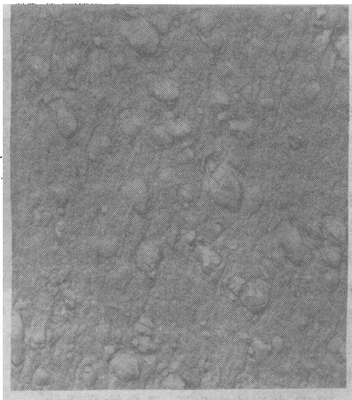
图4 45钢渗碳体球化的 TEM 照片
