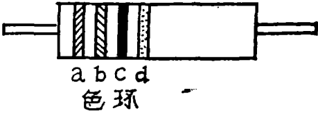
图2 实心炭质电阻值及允许偏差的表示方法
