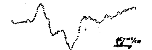
(a)本仪器打印出的诱发电位波( T_A=409.6\text{ms} )
