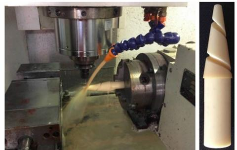
图 5  $RRC_{2s^{new}}$  类新螺旋曲面实体加工
