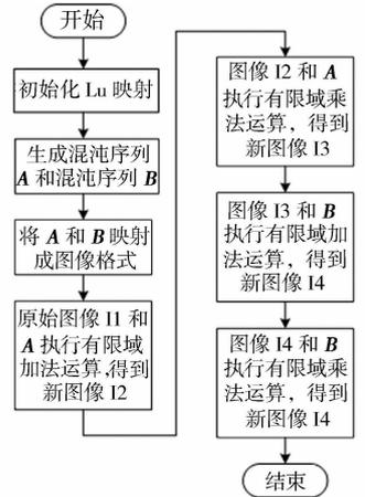
图 1 加密原理及流程图
