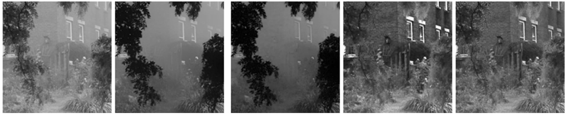
(a) 雾气图像 (b) V(x,y) 初始估计 (c) V(x,y) 最终估计 (d) 图 1(b) 复原结果 (e) 图 1(c) 复原结果
