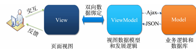
图 6 典型 MVVM 设计模式图 Fig. 6 Typical MVVM design pattern diagram
