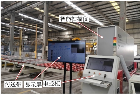
图 2 石材扫描设备 Fig. 2 Scanning equipment for stone
