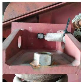
图 2 GLS10 型振动筛传感器安装位置图
