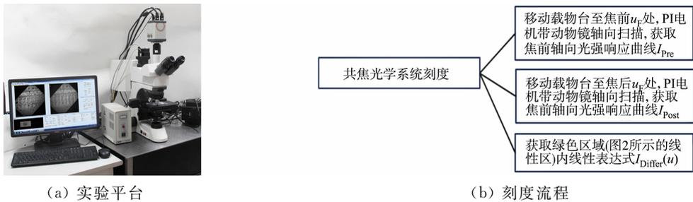
图 5 差动共焦显微测量系统
