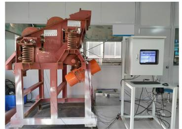
图 6 振动筛悬臂梁故障诊断实验平台
